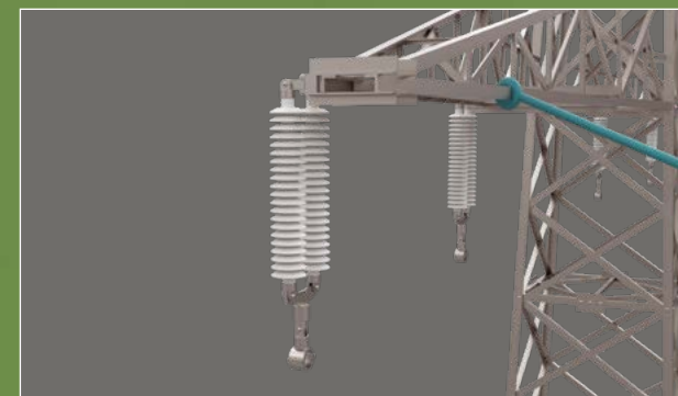
Masttraverse mit Isolator Ketten
