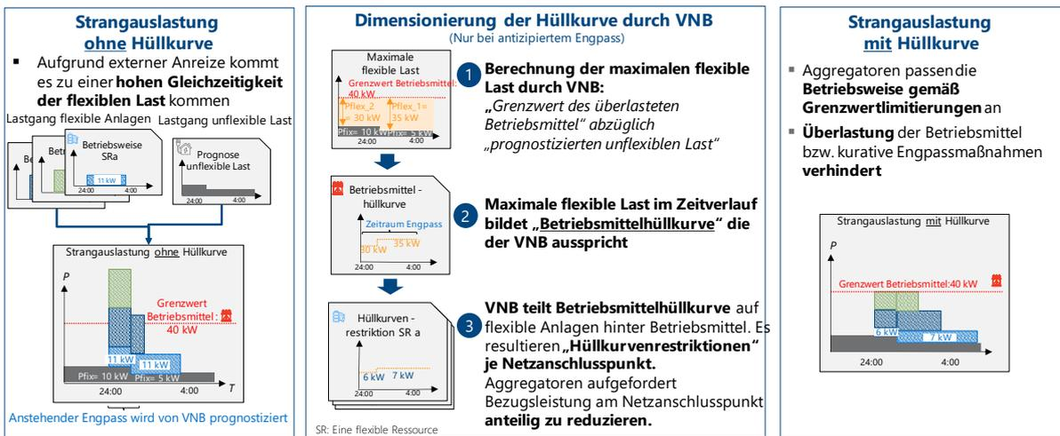
Abbildung 6: Mögliche Auslegung des Hüllkurvenkonzeptes am Beispiel der Limitierung für die Bezugsleistung von flexiblen Anlagen
