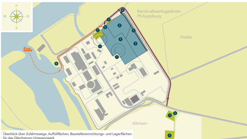
Überblick über Zufahrtswege, Auffüllflächen, Baustelleneinrichtungs- und Lagerflächen für das Gleichstrom-Umspannwerk
