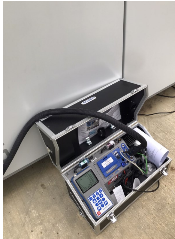
Abbildung 3.20: Darstellung Abgasanalyse: Entnahme und Messgerät
