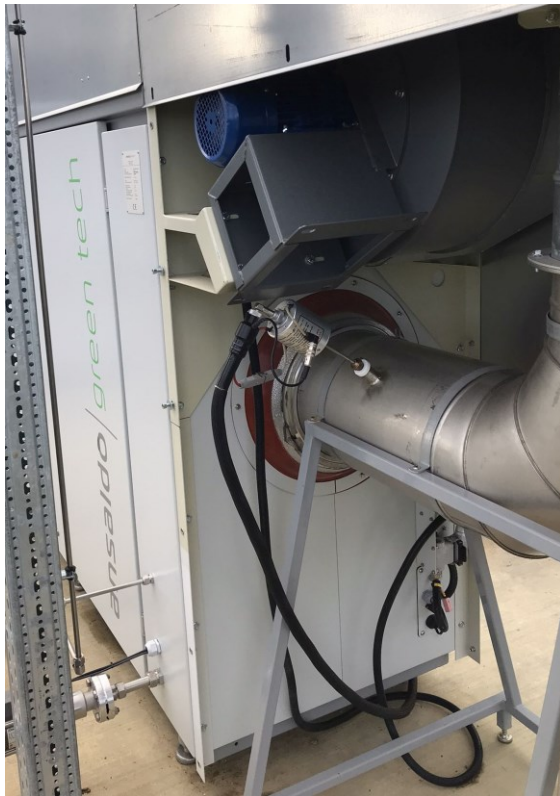
Abbildung 3.20: Darstellung Abgasanalyse: Entnahme und Messgerät
