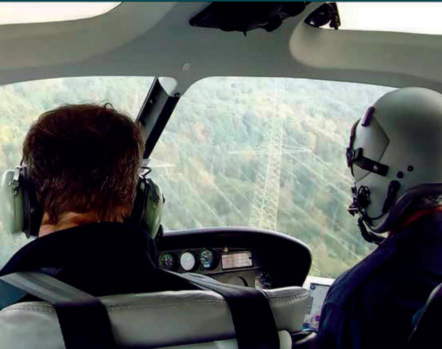
Jährlicher Kontrollflug: Manche Freileitungsschäden können die Monteure von unten nicht erkennen.
