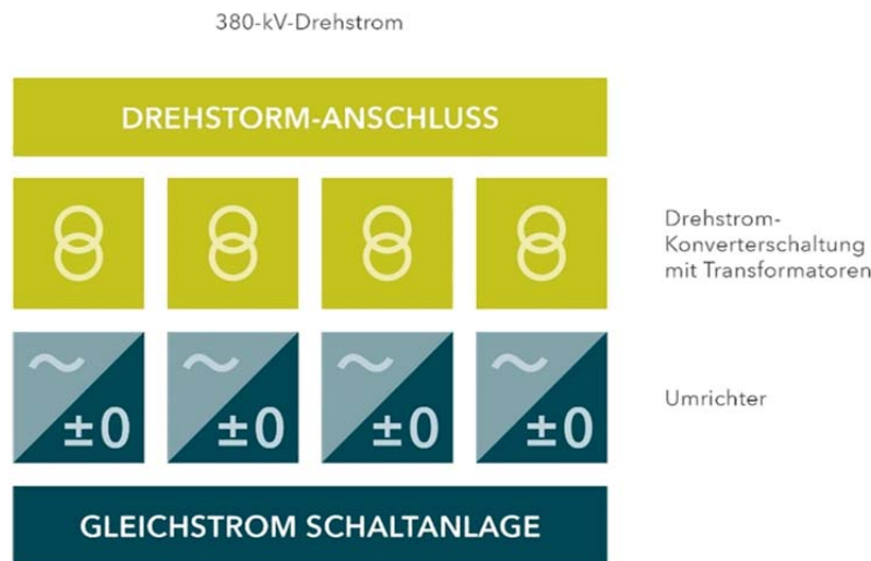
Abbildung 3.1-6 Schematische Darstellung der Funktionsblöcke einer Konverterstation
