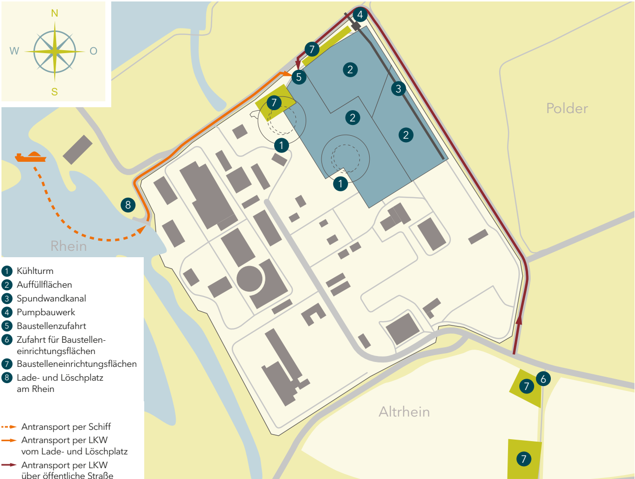
Schematische Darstellung des Konverterstandorts in Philippsburg
