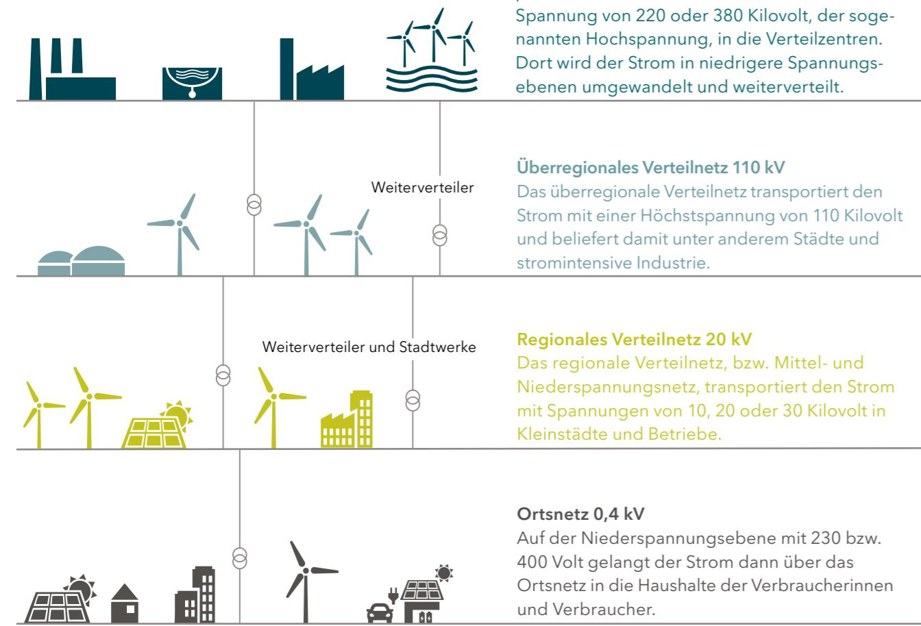
Transformatoren übernehmen in Umspannwerken und -stationen den Wechsel von einer Spannungsebene zur nächsten.
