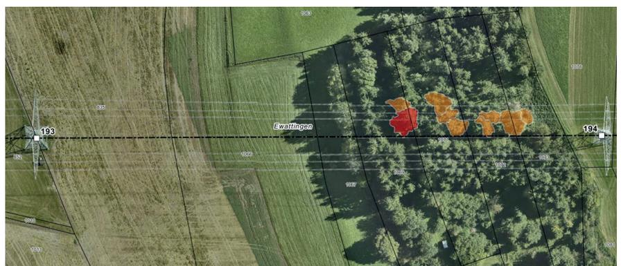
Schneisenmanagement mit dem Einsatz vom Airborne Laserscanning.
