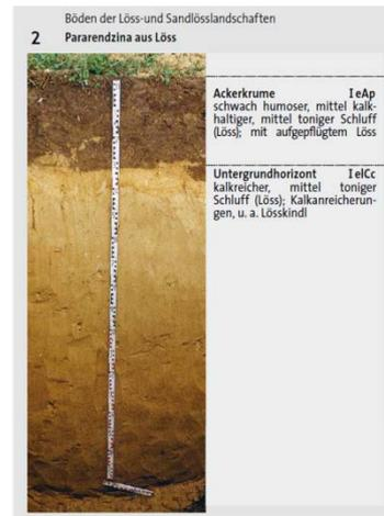
Abbildung 1: Beispiel für Entnahme der Bodenproben sowie für Bodenstruktur in Löss/Sandlösslandschaft
