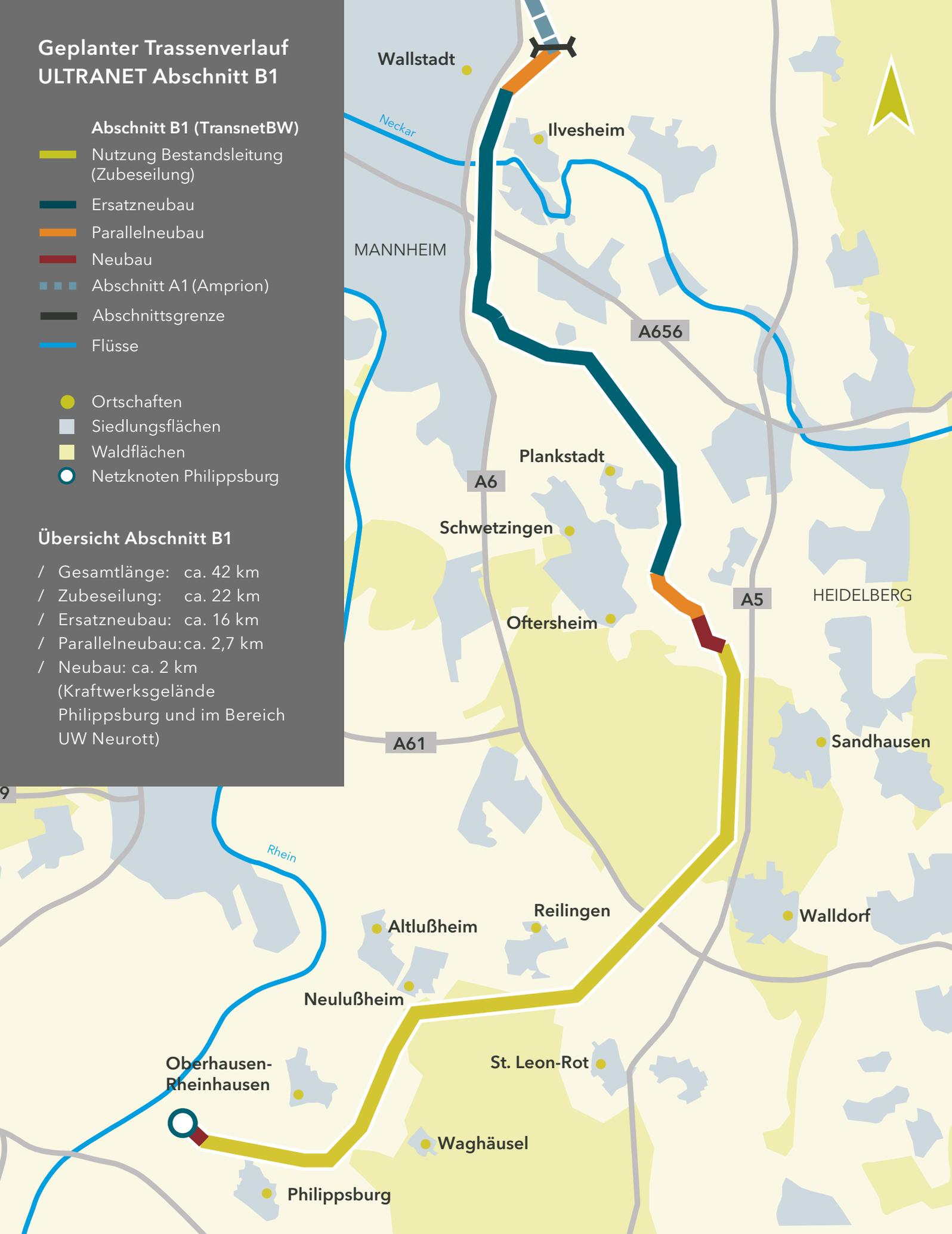
Abbildung 3: Geplanter Trassenverlauf im Abschnitt B1
