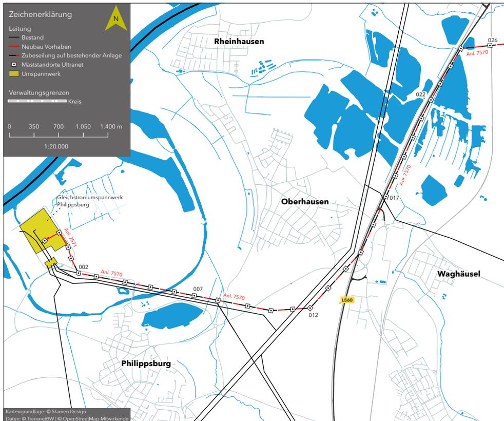
Abbildung 9: Geplanter Trassenverlauf (rot markiert) von der Waghbachniederung bis zum Konverter Philippsburg
