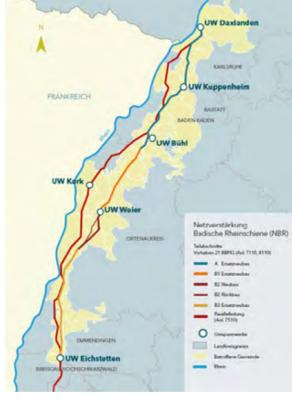
NBR steht für „Netzverstärkung Badische Rheinschiene“ – ein riesiges Energiewende-Projekt, bei dem über 120 Kilometer Leitungstrasse fit für die Zukunft gemacht werden. Konkret bedeutet das, dass die Übertragungskapazität unserer bestehenden Freileitung gesteigert wird.
