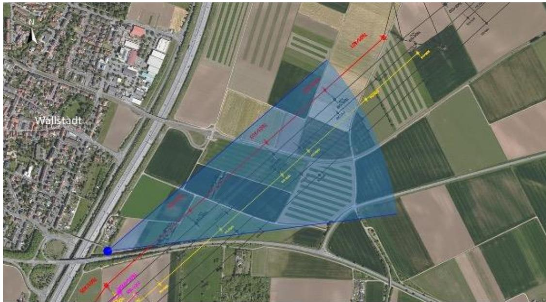
Östlich von Wallstadt wird ULTRANET (im Abschnitt B1) auf fünf neu zu errichtenden Masten als Parallelneubau westlich des bestehenden Trassenbandes geführt.
