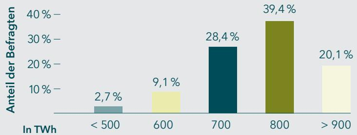
**Ergebnis Stromnetz 2050:** Netto-Stromnachfrage zuzüglich Netzverluste 842 TWh
